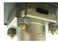
Uchycení pneumatického servopohonu maticemi M5
