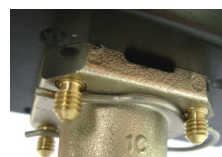
Rychlé uchycení pneumatického servopohonu závlačkou
